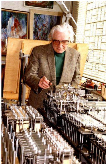
Konrad Zuse: Z1 Mechanische „Schaltungstechnik“
